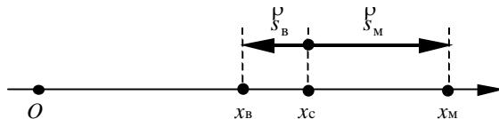
$$x_B = x_C + s_{Bx} = 10 \text{ км} + (-2 \text{ км}) = 8 \text{ км};$$
